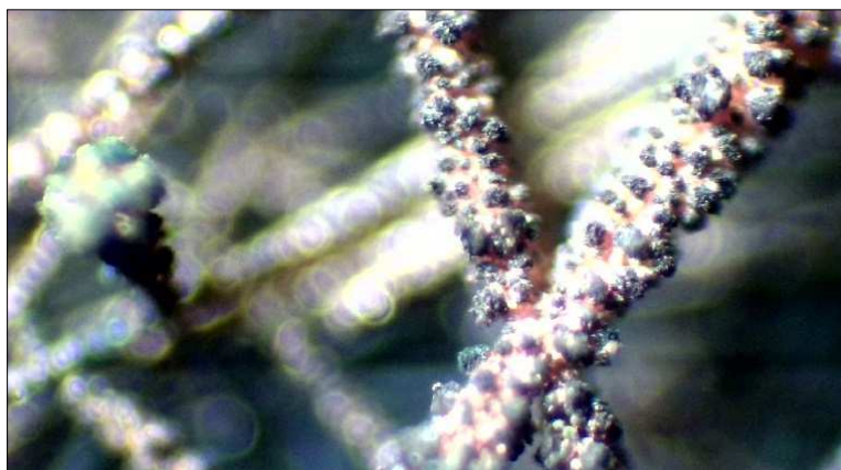
Рис. 1. Углеволокнистый катализатор. Увеличение 40 крат
