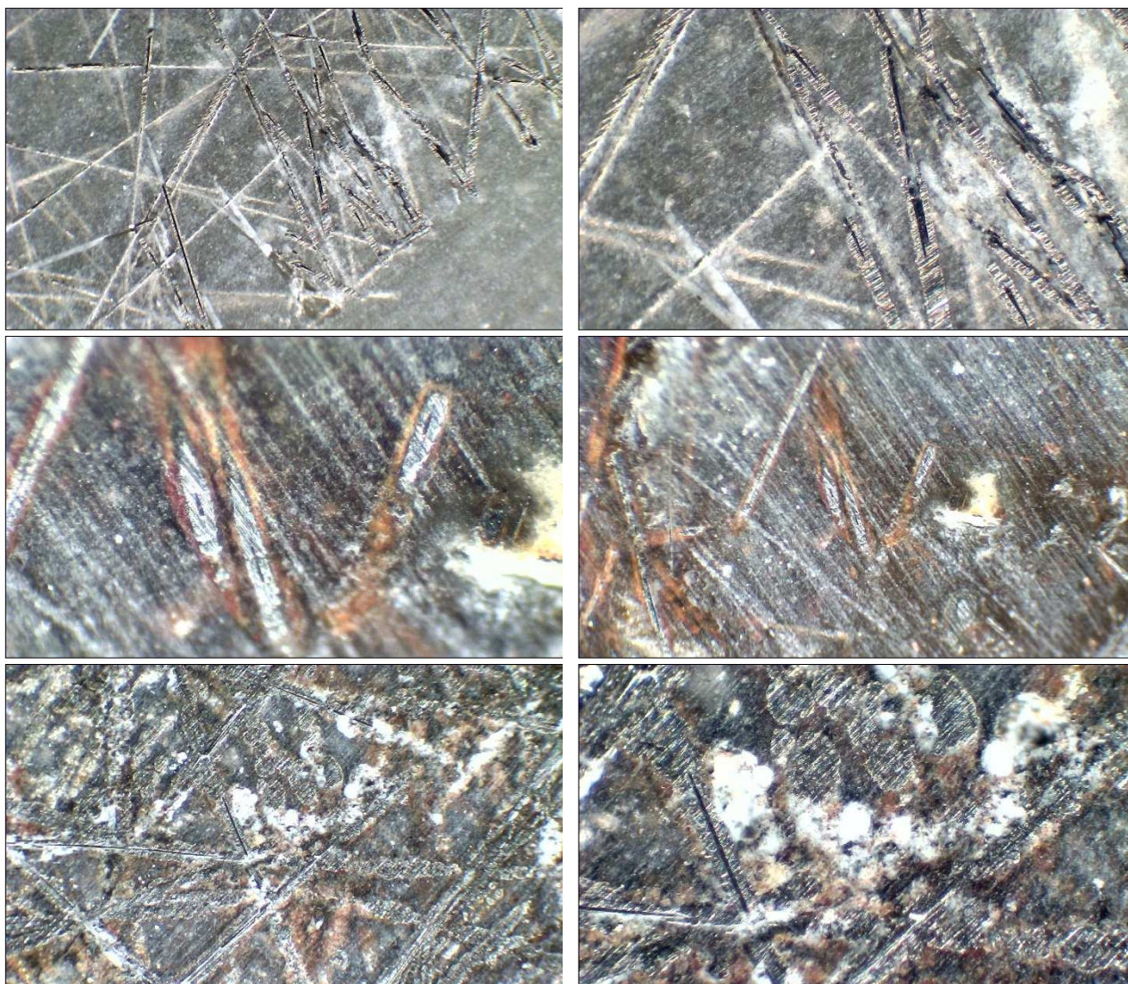
Рис. 2. Экспресс-шлифы углеволокнистого катализатора. Увеличение 10 и 40 крат
