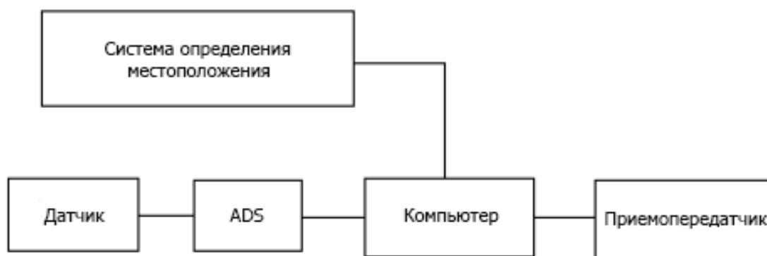
Рис.1. Структура узла сенсорной сети
